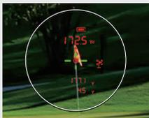
3. 準心對準旗桿時，裝置會發出振動，同時點亮 LED 燈號，測量完成。顯示的距離即為到旗桿的距離。
