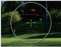
1. 輕按「電源·測量按鈕」開啟電源。將準心對準旗桿後方的物體，按住測量按鈕開始測量。
