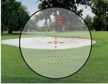
1. 輕按「電源·測量按鈕」開啟電源。將目標標記的中心對準目標物，然後再次輕按「電源·測量按鈕」開始測量。
